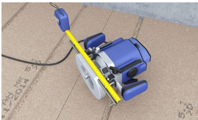
Figur 3 Fræsning udføres med et profilstyr, der sikrer en korrekt blød vending. Profilstyret monteres i overfræsersens land. Afstanden c-c fra penolskrue til fræsebor justeres til brug på 22 mm, 25 mm eller 38 mm gulvplader, se tabel 1.
